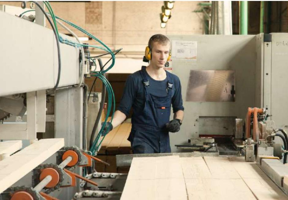
Четырёхсторонние фрезерные станки ведущих европейских производителей позволяют выпускать более 30 видов **профильных деталей**: евровагонка, имитация бруса, блок-хаус, софт-лайн, текстурированная обшивка, двухсторонняя обшивка, доска пола, стеновые элементы, плинтус, наличник, уголок, нащельник, рейка. Этот список постоянно пополняется новыми видами. Более 60% строганой продукции экспортirуется в европейские страны.
